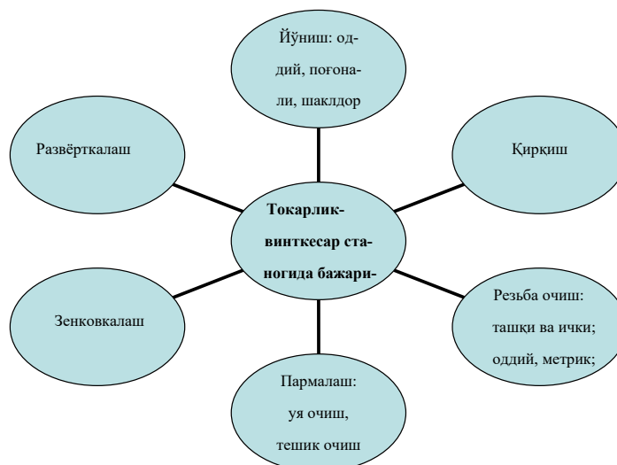
8-расм. Токарлик-винткесар станогиида бажариладиган асосий иш турлари.
