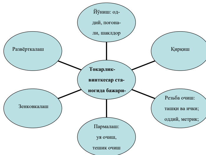
8-расм. Токарлик-винткесар станогиида бажариладиган асосий иш турлари.
